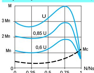
На рисунке показаны механические характеристики короткозамкнутого асинхронного двигателя в зависимости от напряжения питания.
