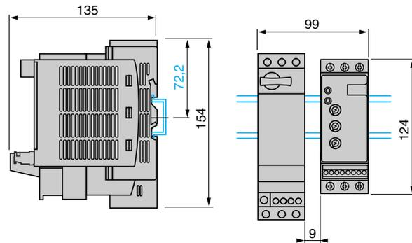
**Система TeSys модели U (силовой модуль с одним направлением вращения) и ATSU 01N222LT - ATSU 01N232LT**
