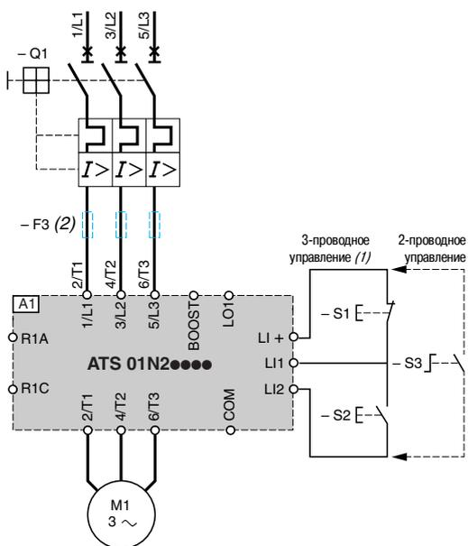
Автоматическое управление с замедлением или без него, с контактором
