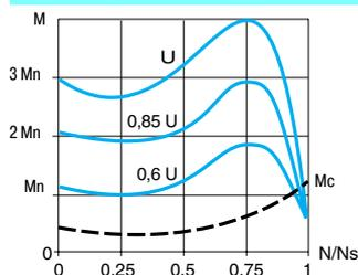
На рисунке показаны механические характеристики короткозамкнутого асинхронного двигателя в зависимости от напряжения питания. Момент изменяется в квадратичной зависимости от напряжения с фиксированной частотой. Постепенное увеличение напряжения устраняет мгновенный бросок тока при подаче напряжения.
