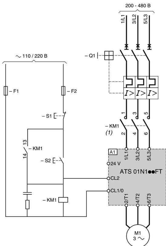
Примечание: для однофазных двигателей используйте ATS 01N1●●FT без подключения второй фазы 3/L2, 4/T2.
