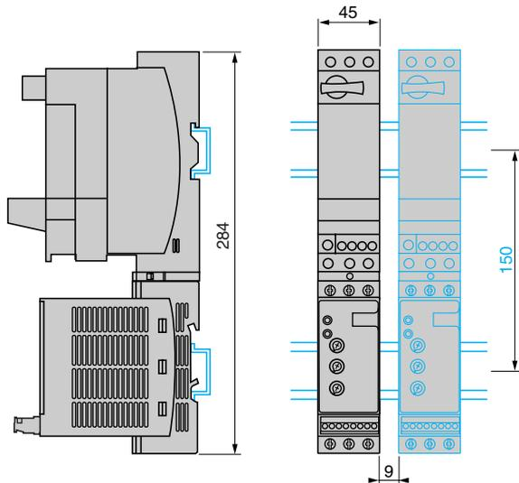
**Система TeSys модели U (силовой модуль с одним или двумя направлениями вращения) и ATSU 01N206LT - ATSU 01N212LT**
