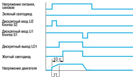
A1: устройство плавного пуска и торможения
