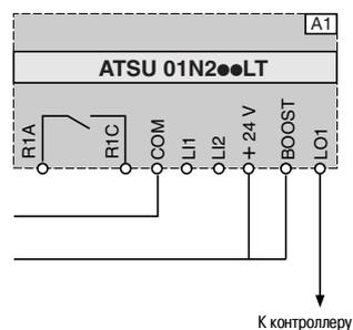
A1: устройство плавного пуска и торможения
