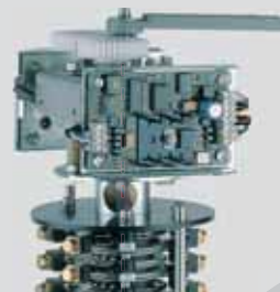
Шифратор с рукояткой и плата шин-контура, подсоединенные к кольцевому токосъемнику
